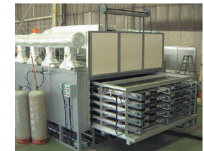
既存プレス機に合わせたパネル予熱炉
